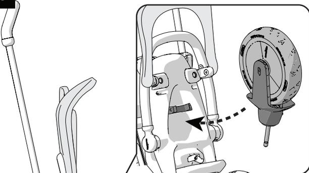
図の向きで前輪を背もたれの後部に押し当てて固定し、幌を下ろします。
