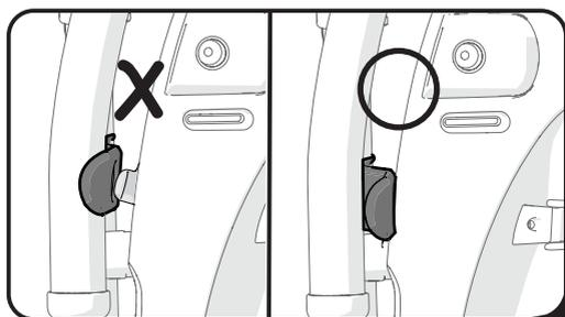
図のようにロックレバーが留め具に引っかかるようにロックします。安全ガードとコントロールバーを両手で挟んで握るとロックしやすいです。
