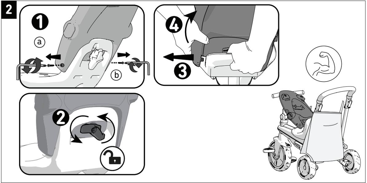
背もたれのネジを付属のドライバーで外し、背もたれのロックを解除して、背もたれ付け根とシートの取っ手をもちながら、外側に向かって引き上げます。**※指を挟まないよう注意してください。**
