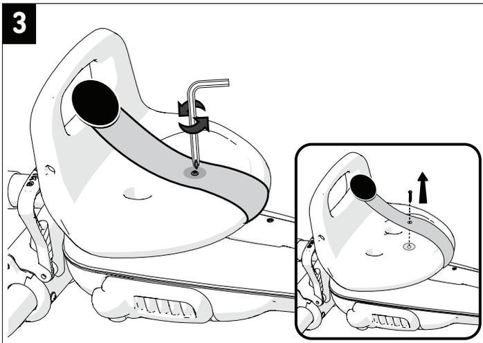
股ベルトを固定しているネジを外します。
