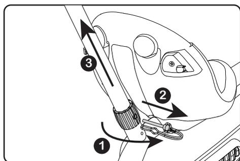
(1)(2)ピンを外し(3)コントロールバー(押し棒)を抜きます。
