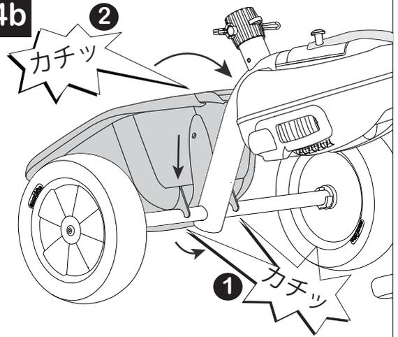
カゴ(F)の溝を本体の軸に合わせて取り付けます。
