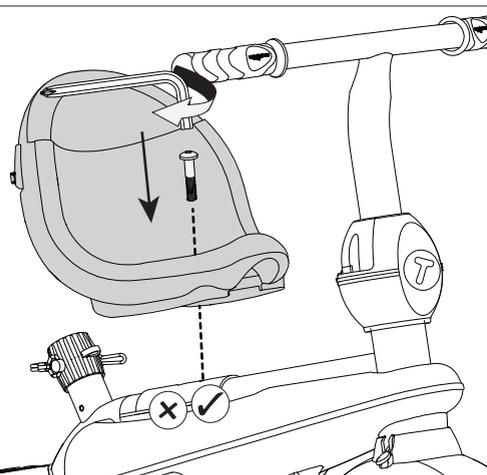
お子様がご自分で漕げるようになったらハンドルに届くようにイスを前方に移動します。ネジとまたベルトを外し、イスを前の穴でネジを固定します。
